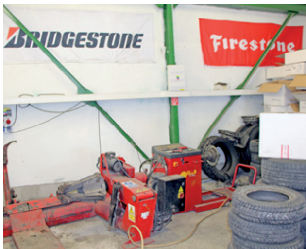
V priestoroch spoločnosti EL-ZET Slovakia s.r.o. sa nachádza profesionálne vybavenie pre montáž, demontáž pneumatiky z disku, jej opravu, ako aj vulkanizačné zariadenie.
